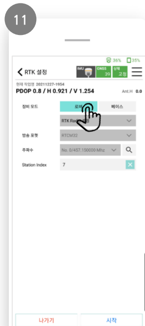
[로버 설정] 로버로 이용할 수신기를 장비연결 후 [환경설정]-[RTK 설정]- [로버] 설정 진행
