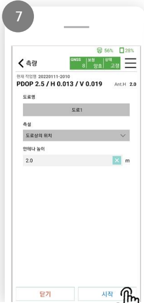
측설 유형 [도로상의 위치] 선택 및 안테나 높이 입력 후 [시작] 클릭
