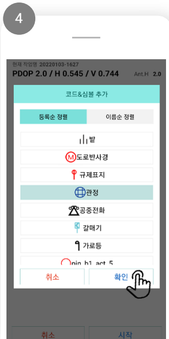
추가된 코드 정보 확인 및 사용할 코드 선택 후 [확인] 클릭
