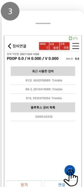
[돋보기] 클릭, GNSS 수신기 검색 후 연결할 장비 클릭 (연결할 장비의 이름과 시리얼 넘버를 확인)
