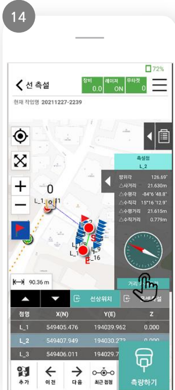
측설 점 선택 후 [거리 가져오기] 클릭 -측설선의 좌우 읍셋으로 측설점이 생성됩니다.
