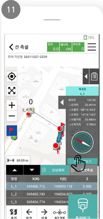
측설 점 선택 후 [거리 가져오기] 클릭 -1m간격으로 초록색 선을 따라 측설점이 생성됩니다.
