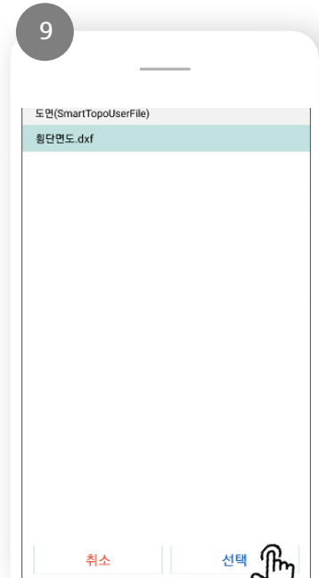
해당.dxf 파일을 선택 후 우측 하단 [선택] 클릭 -경로는 (내PC)\Phone\Download\SmartTopo\UserFile)입니다.
