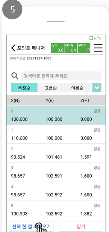
목록에서 추가 선택 후 [선택 한 점 가져오기] 클릭 또는 직접입력 후 [추가] 클릭
