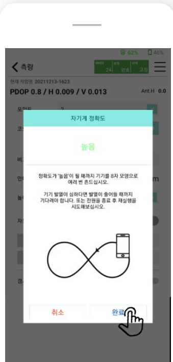
c.그림과 같이 사용하는 기기를 동작 [자기계 정확도 높음] 확인 후 [완료] 클릭
