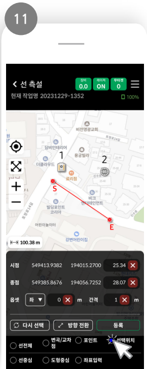
[선택위치] 측량 점 선택 후 선으로 이을 2개의 점 등록 및 측정 간격 설정
