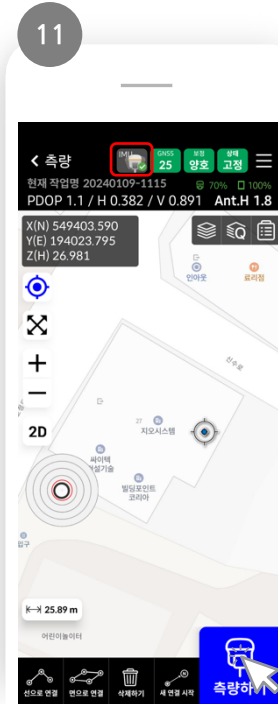
측량하기 클릭 - IMU 측량 시 화면에 경사센서 버블이 표시됩니다.
