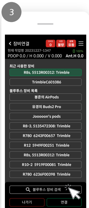
[돋보기] 클릭, GNSS 수신기 검색 후 연결할 장비 클릭 (연결할 장비의 이름과 시리얼 넘버를 확인)
