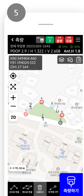
코드 측량 화면 - 사용자가 원하는 코드를 다양하게 사용 가능하며 각 코드별로 레이어가 자동 생성되어 관리가 용이합니다.
