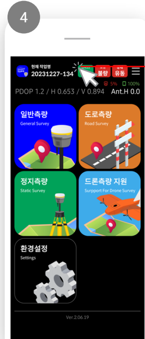
[연결] 클릭 시 상단의 GNSS 상태BAR가 초록색으로 활성화 - '연결성공' 메시지가 뜨면 [닫기] 클릭
