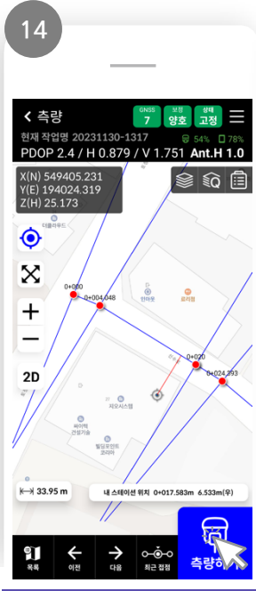
[도로상의 위치] 측정 화면
